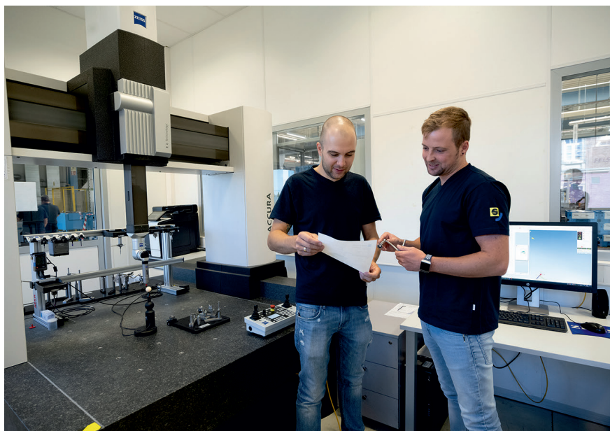
Bild 2. Mit einem Koordinatenmessgerät überwachen Steffen Sauer (links) und Patrick Falkenstein aus dem Qualitätsmanagement alle Fertigungsschritte. © ZEISS
